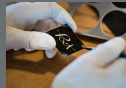
Das POET Logo wird von Hand foliert und innen auf das Stahlblech geklebt.
